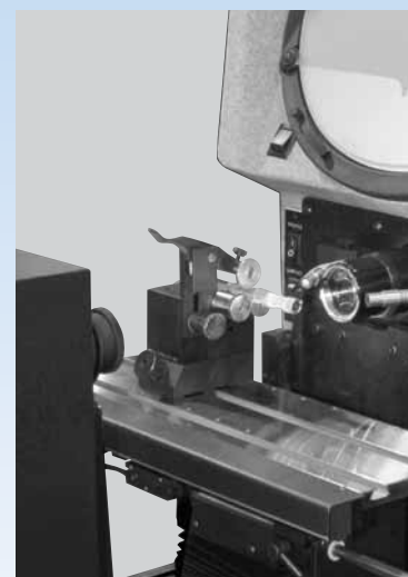
拡大投影機で振れの測定(JSLP-10C)
