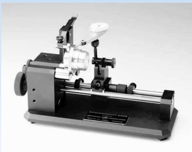
モデルG1-10/110-10FP (横振れテストインジケータークャリアーをサイドインジケータークャリアーにセットしワーク端面の直角度を測定)
