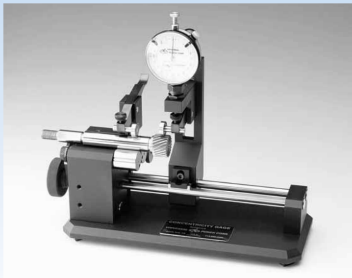
モデルE-10/110-10FP スプライン形状の外径部の測定も ローラーを介しますので可能です。
