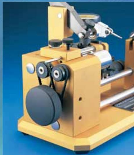
全てのゲージには手動タイミングベルト／ブーリーによる駆動システムが標準装備となっており、測定するワークを連続的且つスムーズに回転させる事が出来ます。オプションとしてDC24V可変速タイプのモータードライブシステムをセットする事も可能です。
