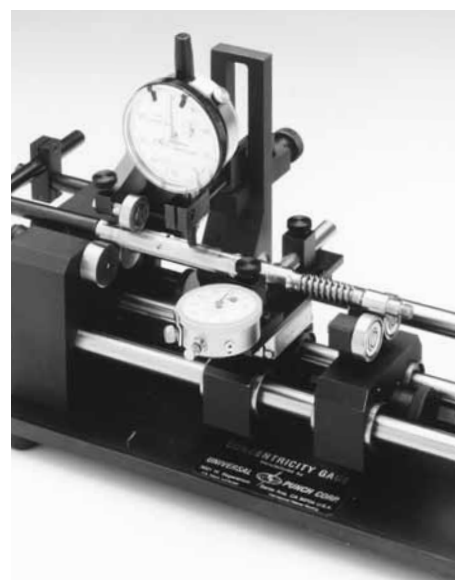
フロントインジケーターカーrier等（オプション）を使用すると標準のダイヤルゲージキャリアーに加えて横位置より径の測定が出来ます。
