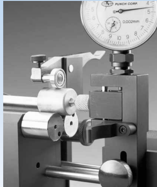
ヘッダーパンチリセスの振れ測定。 (リニアフローティングキャリアに取り付けるプローブは雌型となります)
